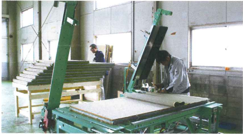
工場内での畳張り替え作業の様子
